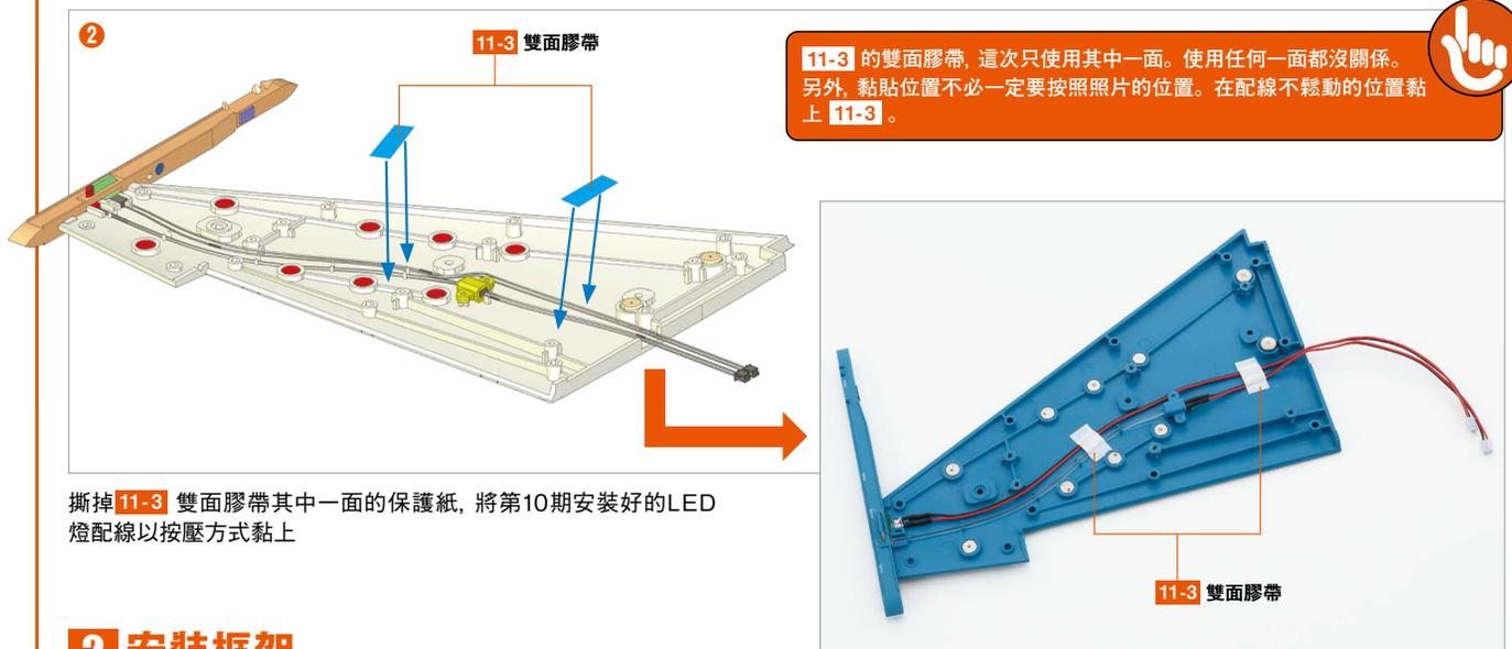
撕掉 11-3 雙面膠帶其中一面的保護紙,將第10期安裝好的LED燈配線以按壓方式黏上
