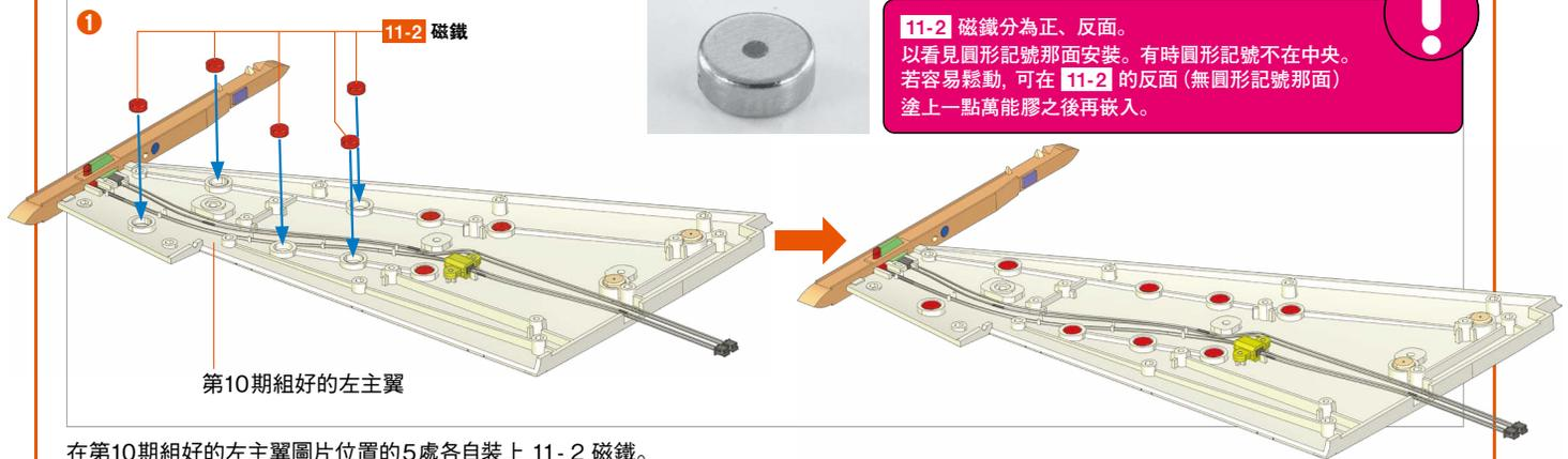
在第10期組好的左主翼圖片位置的5處各自裝上 11-2 磁鐵。
