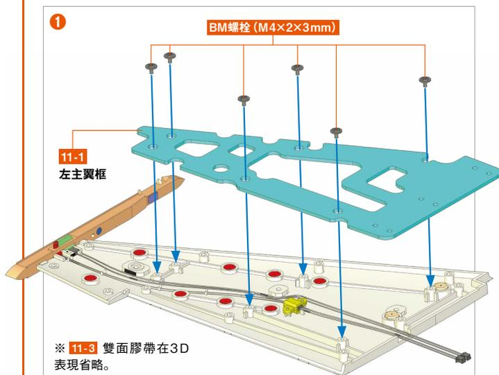
1 在1組好的左主翼的圖片位置安裝 11-1 左主翼框,在6處鎖上BM螺栓(M 4×2×3 mm)固定。
