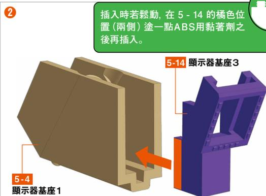
在 5-4 顯示器基座1的圖片位置插入 5-14 顯示器基座3。
