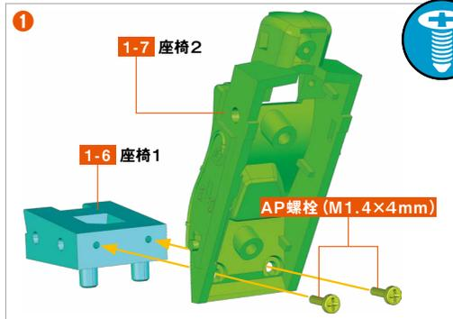
將1-6座椅1及1-7座椅2按圖所示組裝起來，從1-7這一側以2支AP螺絲 (M1.4x4mm) 固定。
